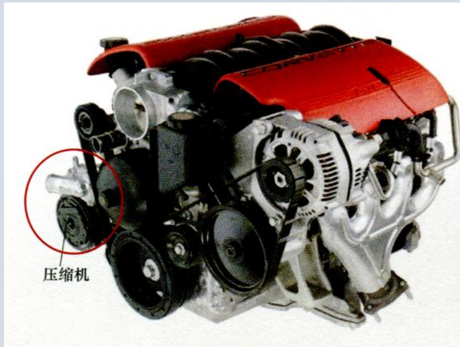
传统汽车传动带动空调压缩机
