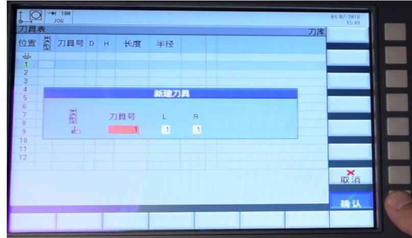
4. 输入刀具长度和刀具半径，完成新刀具的建立。
