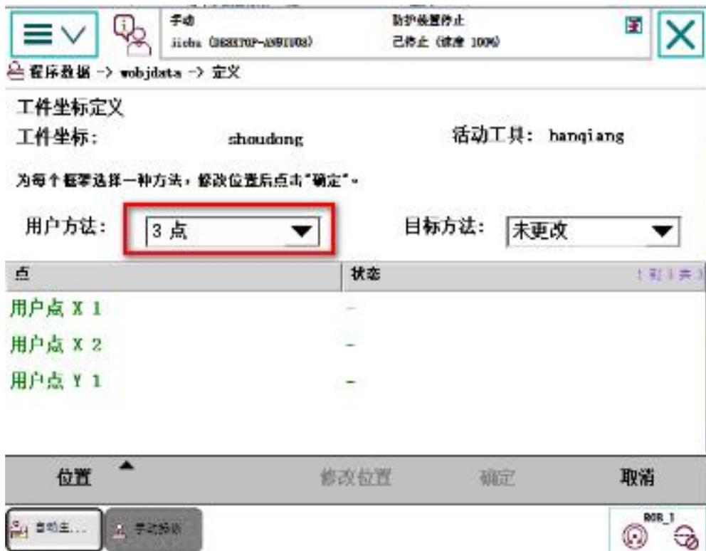
4) 在显示工件坐标定义窗口，将用户方法设定为3点，如图所示。
