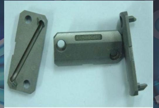
结构的特点是结构简单，制造方便，承载能力大，缺点是滚珠流畅性较差，挡珠器较易磨损。
