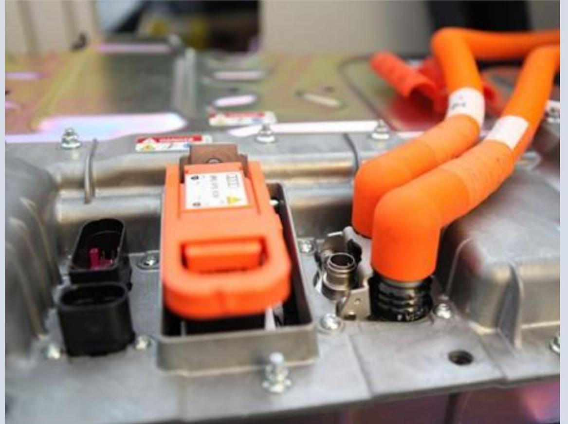
新能源汽车维修开关
