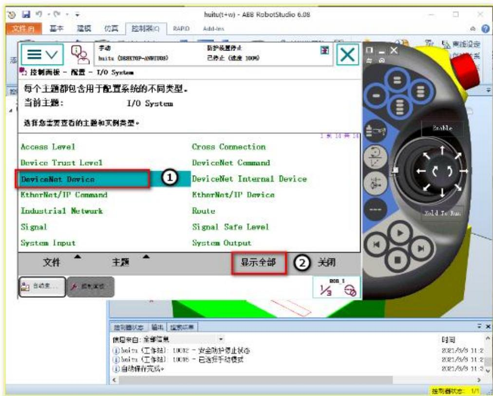
3) 进入配置界面，单击“DeviceNet Device”，进行I/O信号板的配置，单击显示全部，如图所示。
