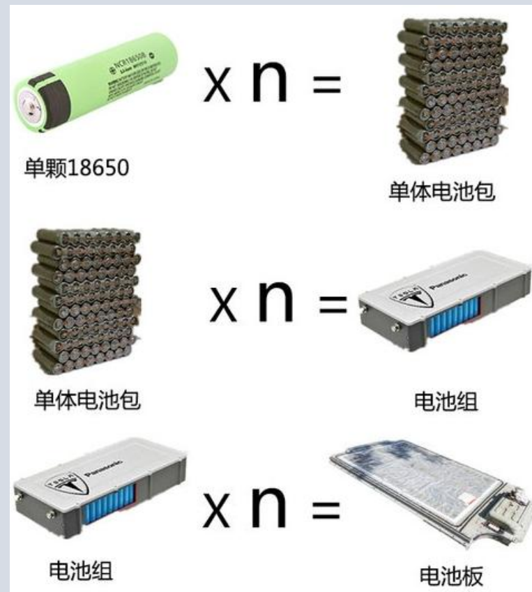
特斯拉Model S电芯连接方式
