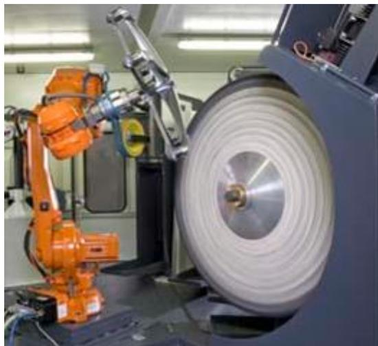
工业机器人+砂轮打磨机
